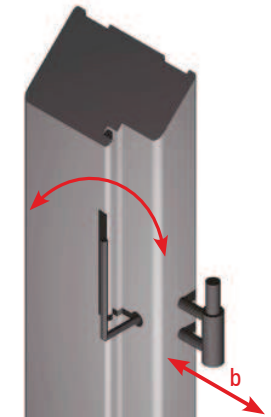
Rys. 3b regulacja zawiasu w ościeżnicy
